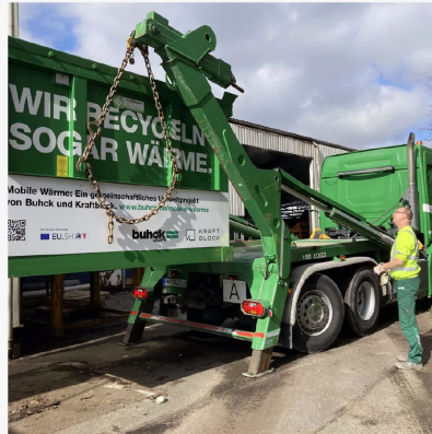
LKW, der gerade den Mobile-Wärme Container absetzt. Er gehört zu den Projekten, mit denen das Unternehmen sich aus eigener Kraft klimaneutral stellen möchte. Fotos: Buhck-Gruppe
