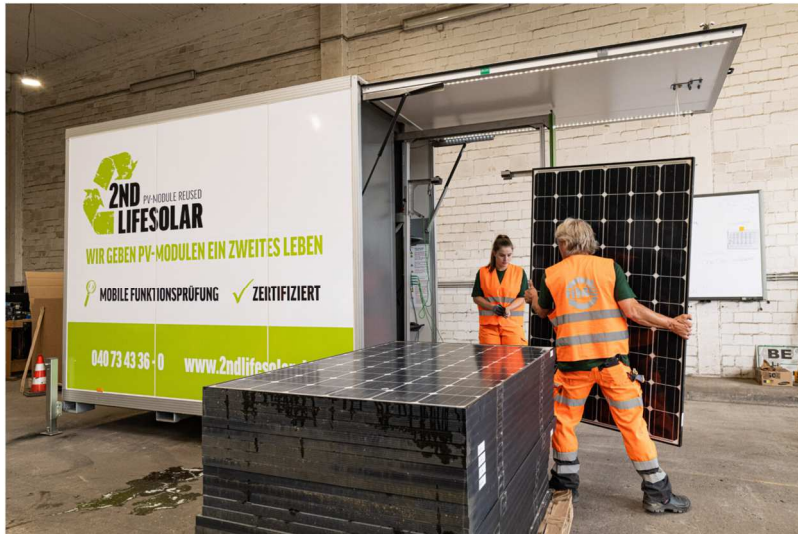
Mit dem mobilen Prüflabor nimmt 2ndlifesolar beim Kunden vor Ort eine Ersteinschätzung vor. Dabei werden Defekte aufgespürt, die in einer Sichtprüfung nicht erkennbar sind. Bild: Buhck Gruppe
