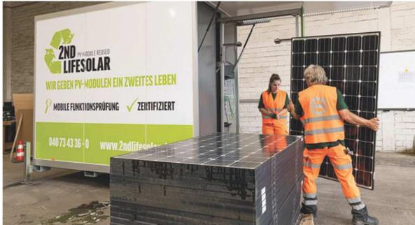
© Buhck.de | 2ndlifesolar.de | Mit dem mobilen Prüflabor nimmt 2ndlifesolar beim Kunden vor Ort eine Ersteinschätzung vor. Dabei werden Defekte aufgespürt, die in einer Sichtprüfung nicht erkennbar sind.
