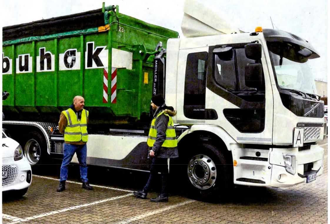
Dominic Burzlaff (l.), Fuhrparkleiter beim Entsorger Buhck, berichtet Youtuber Felix Goldbach über den Test des E-Lkw. Der FE Electric von Volvo ist durch seine vier Batterien hinter den Vorderrädern in Leergewicht zwar 1,3 Tonnen schwerer, aber beschleunigt viel schneller und ist extrem leise. FOTO: BUHCK
